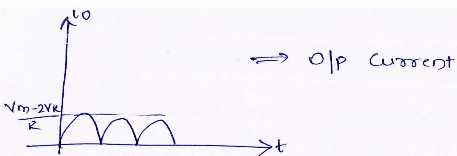
$$\text{W.E.T } V_{dc} = 0.636 V_m.$$
